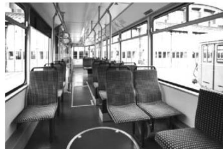
Nebst den technischen Modernisierungen, die eine höhere Laufruhe und weniger Lärmentwicklung mit sich bringen, wird der Innenraum neu mit Einzelsitzen ausgestattet sein.
